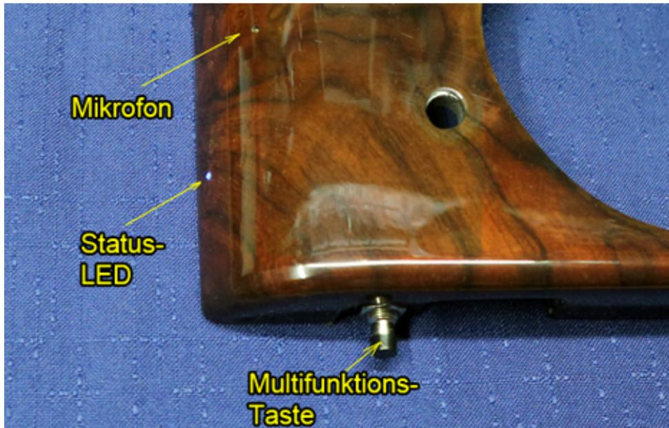
Das Foto zeigt einen Ausschnitt der Konsole eines **BECKER Solitude**. Auf der Rückseite wurde ein modifizierter **AUKEY-Bluetooth-Receiver** eingebaut. Dieser wird nur noch über drei Elemente bedient (s. Foto). Zusätzlich werden Sie durch Ansagen des Radios unterstützt.
